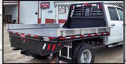
**ZIMMERMAN ALUM COMBO FLATBED,** STEEL FRAME, ALUM BODY W/B&W GN HITCH, REAR RECEIVER HITCH, ALL LED LIGHTS
